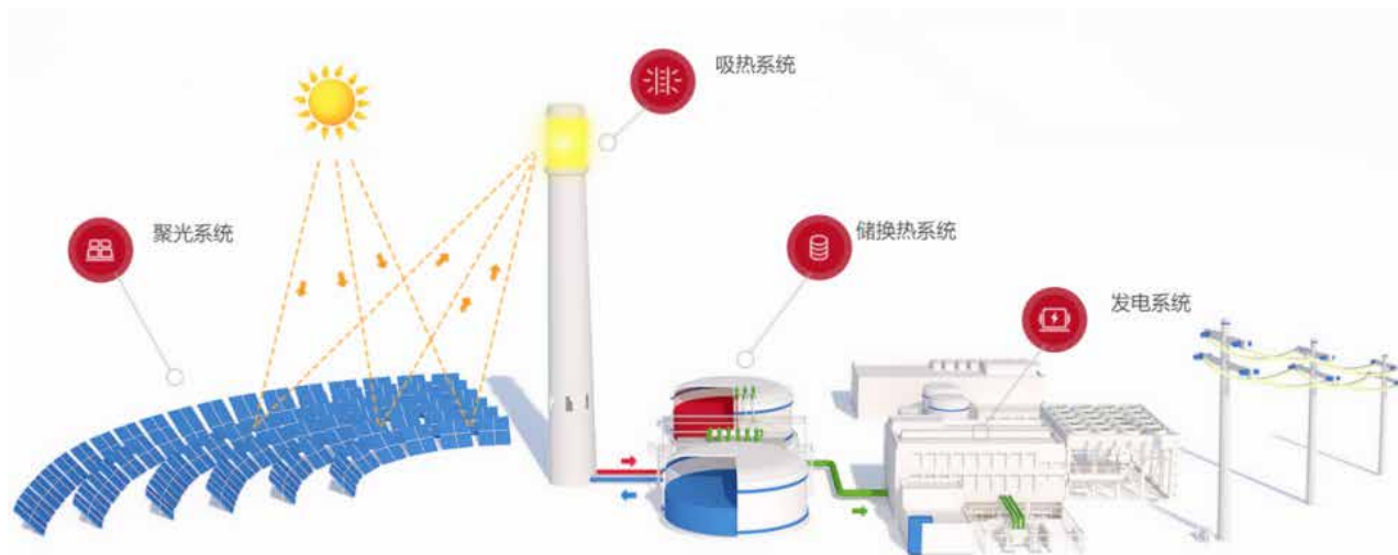
图：熔盐塔式太阳能热发电系统示意图（图片来源：可胜技术）
