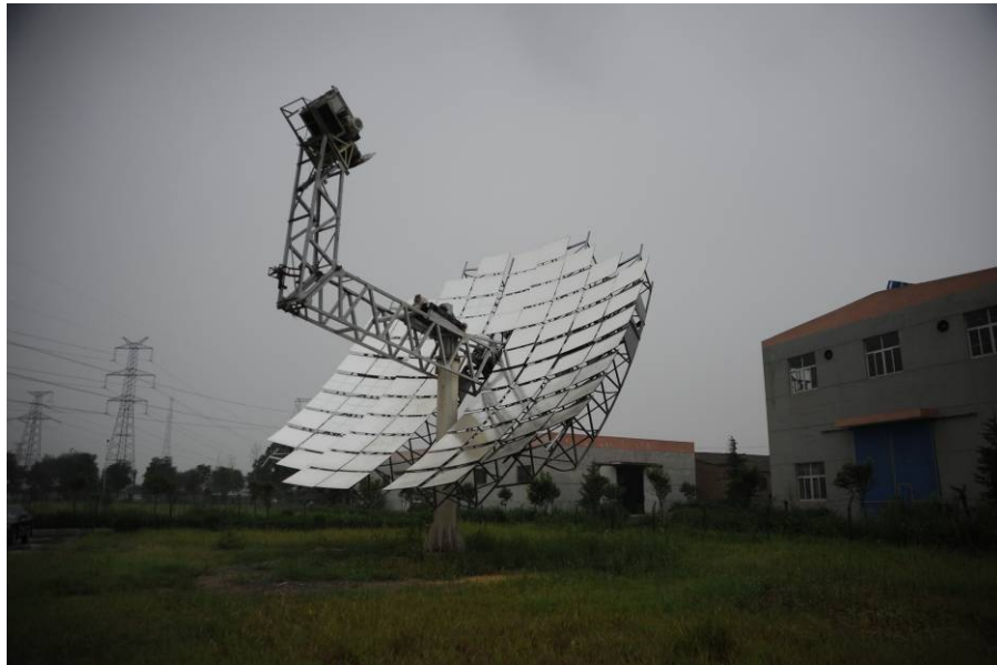
图 3-18 西航动力公司的碟式斯特林系统
