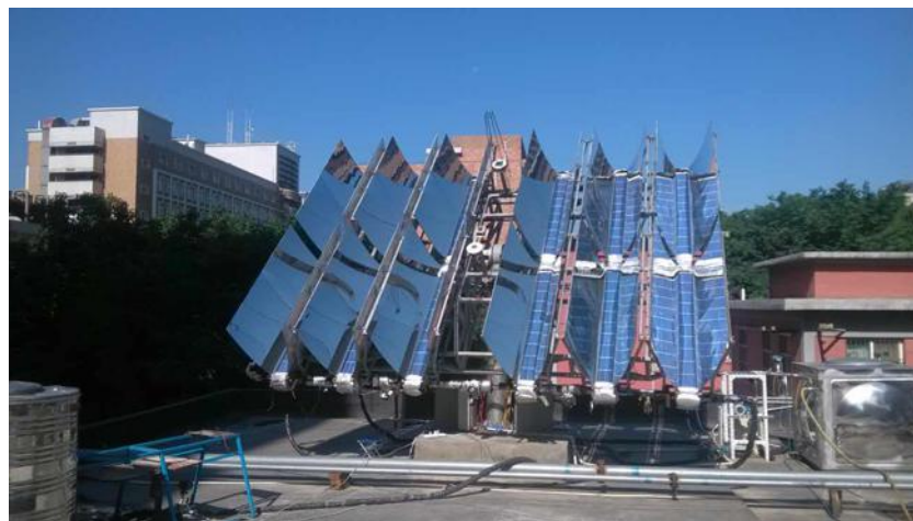
西安交通大学 12m 2 双轴跟踪聚光光伏/光热综合利用实验台
