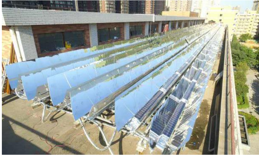
西安交通大学 168m 2 单轴跟踪聚光光伏/光热综合利用实验台
