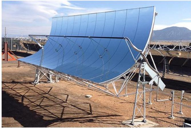
图：做性能测试的 SkyTrough®DSP 模块
