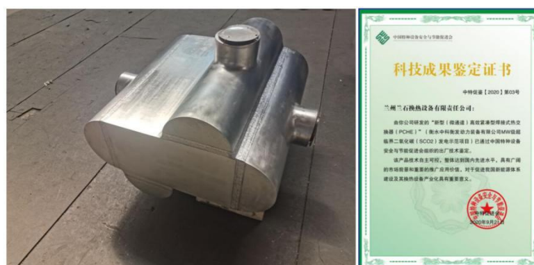
新型（微通道）高效紧凑型焊接式热交换器（PCHE）
