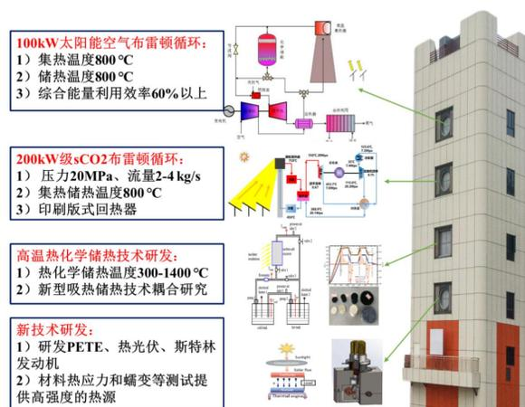
拥有浙江大学青山湖能源研究基地太阳能热发电实验室，试验平台占地约1万平方米，定日镜面积2000平方米、吸热塔最大热功率可达1000千瓦，可用于高温集热、热化学储热、布雷顿循环、斯特林循环等先进技术的研究。先后主持/完成10余项太阳能热发电方面的课题（包括国家自然科学基金、国家重点研发计划、企业横向项目、浙江省重大科技专项等）。已发表SCI论文55篇，授权发明专利60余件。
