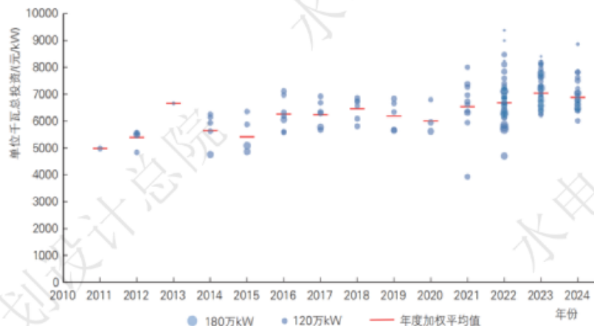
“十二五”以来核准抽水蓄能电站单位千瓦总投资变化趋势 (图中气泡面积大小代表装机规模)
