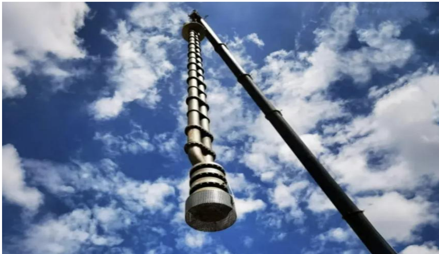
青豫直流二期10万千瓦光热项目高温熔盐泵
