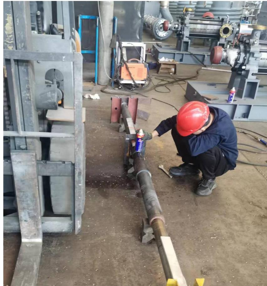
进口熔盐泵产品在青海德令哈某光热发电公司使用中出现故障，由于接轴部件热变形导致现场无法拆卸，进而造成接轴螺纹损坏。后由双达公司协助修复：采用对原有螺纹进行车削后增材补焊并重新加工螺纹的修复工艺，完工复装后完全满足使用要求。
