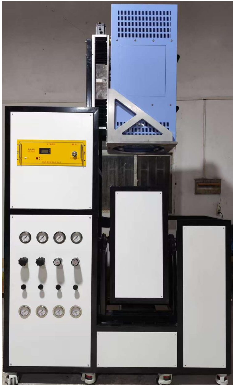
图 3 太阳能热化学氢热联产装置实物图
