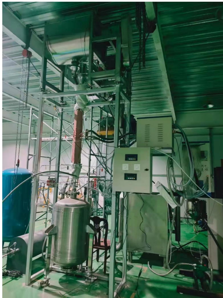
单管密相气固逆流式流化床粒子吸热器实验流程图 (左) 及高温实验系统实拍图 (右)
