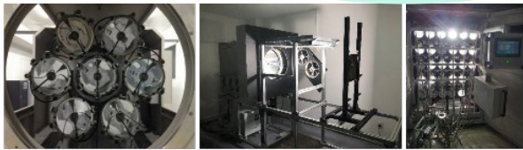
百kW级高功率太阳能模拟器 高精度功率可调太阳模拟器 基于光纤束传输的灯阵列光源
