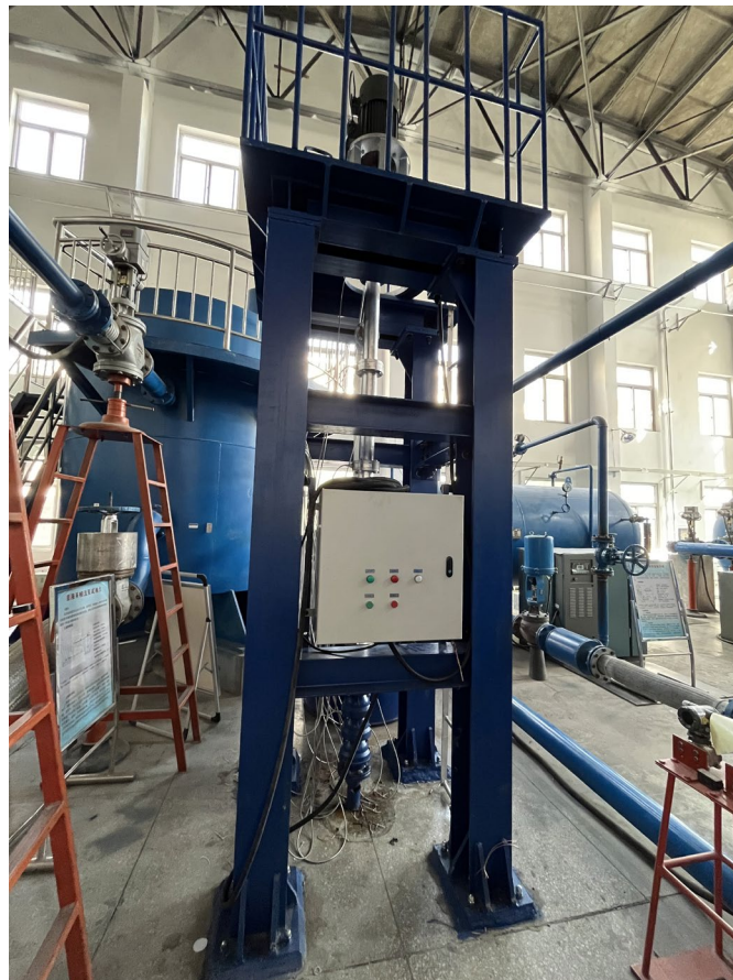
长轴泵转子动力学特性实验
