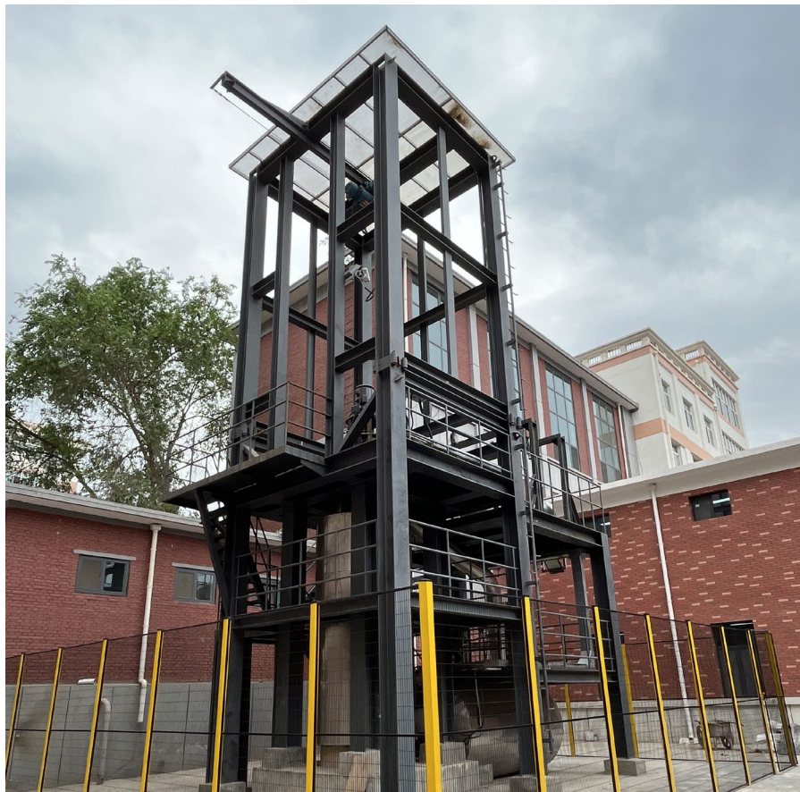
熔盐泵性能测试实验台 塔式太阳能光热发电技术研究
