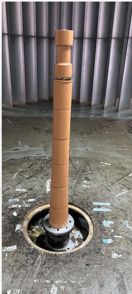
左图为模型的制作与风洞模型成品的展示，分别为芯梁制作与风洞安装模型，图中白色圆盘部分为配重盘，用于模拟质量参数，右侧为加装了外衣的完整模型
