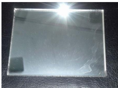
玻璃反射镜的风沙磨损实验
