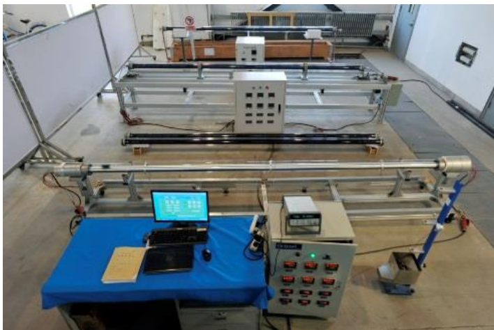
吸热管热损试验平台 (CSP-IEECAS)
