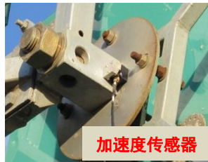
定日镜自振频率和模态振型测试
