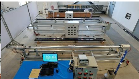
槽式吸热管热性能测试平台
