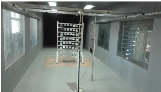
玻璃反射镜的风沙磨损实验
